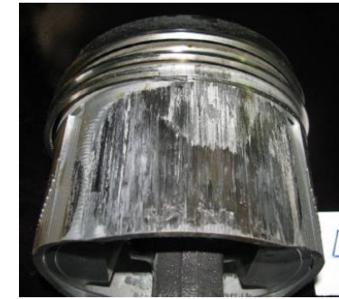
Задиры поршня четвертого цилиндра
