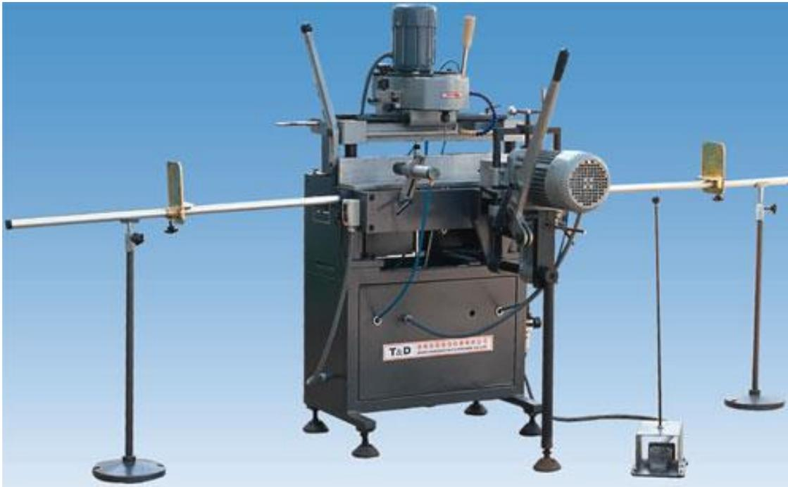
Копировально-фрезерный станок для обработки отверстий замка SZS-100. Обеспечивает сверление 3-х параллельных отверстий для замочного паза.
