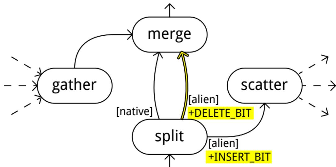
Модифицированный алгоритм exchange позволяет перемещать кортежи, которые в результате обновления стали «чужими» (если  $\varphi(t') \neq \varphi(t)$ , то на узле  $\varphi(t)$  кортеж  $t$  удаляется, а на узле  $\varphi(t')$  вставляется  $t'$ ).
